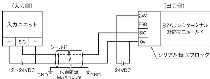
☀ 図は伝送ケーブルにシールド線(芯線断面積0.75mm<sup>2</sup>以上)を使用した場合です。シールドラインは大地接地をおすすめします。(“-”や“OV”端子には接続しないでください)シールド線を使用しない場合はMAX.10mです。(VCTF0.75mm<sup>2</sup>使用)
