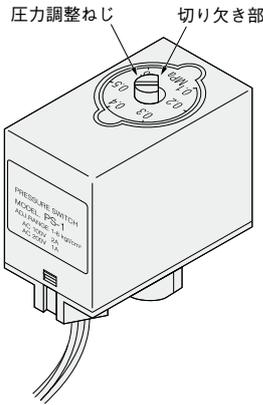
**注** 圧力指示目盛板は目安としてください。より正確な圧力の調節は、圧力計を接続して行ってください。
