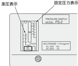
**注** 目盛板の数字には、0.05MPa未満ですが誤差があります。微調節をするには、設定圧力の圧縮空気を印加してスイッチの切換えを確認しながら行ってください。
