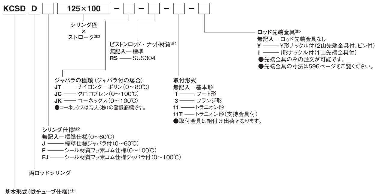
注1: **KCSD**形シリンダは、 $\phi 125, \phi 140, \phi 160, \phi 180, \phi 200, \phi 250$ の鉄チューブ仕様のシリンダです。センサスイッチは取付けできません。
