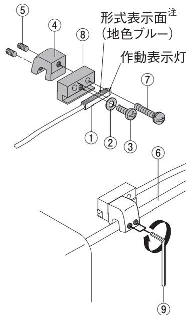
1. ●センサホルダ④のめねじとサブホルダ⑧の通し穴の位置を合わせ、小ねじ(長)⑦を使用して組み立ててください。
