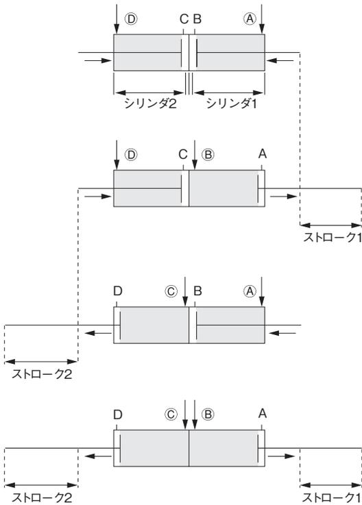
①、④ポートより空気圧を供給すると、2、1両ストロークは引込みます。
