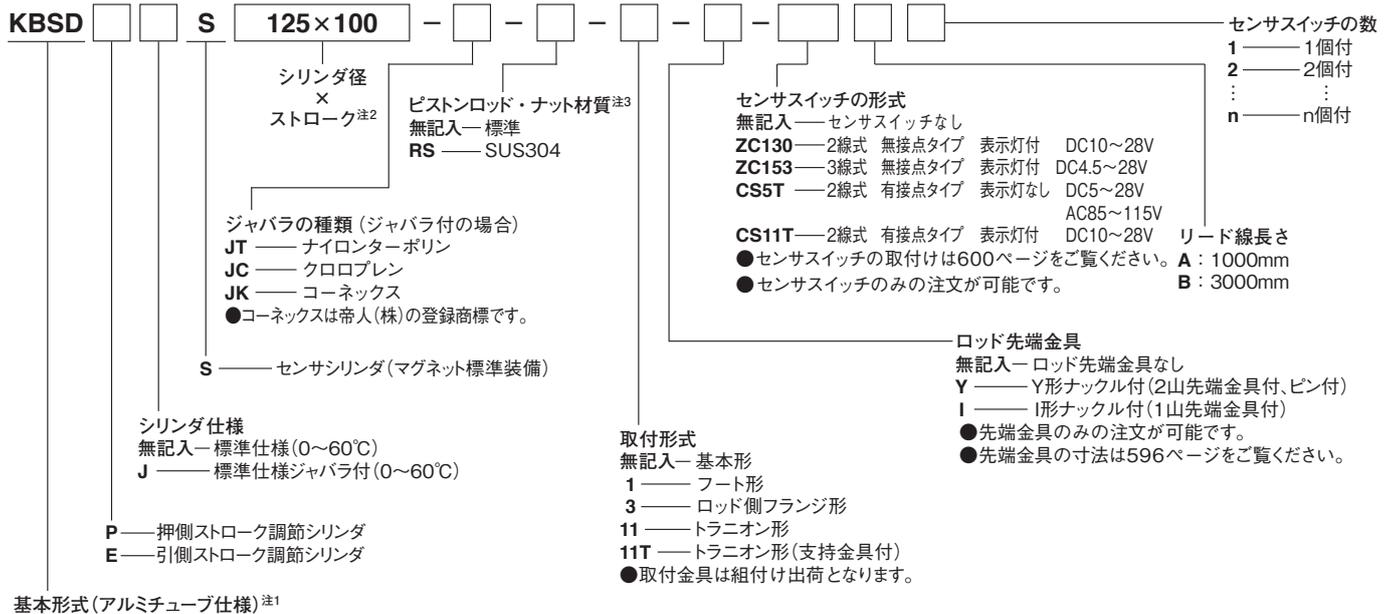
注1: **KBSD**形シリンダは、 $\phi 125, \phi 140, \phi 160$ のアルミチューブ仕様のシリンダです。オプションでセンサスイッチの装着が可能です。
