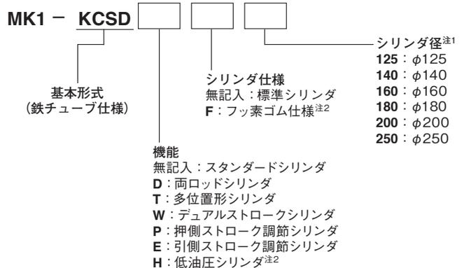
注1：引側ストローク調節シリンダのシリンダ径はφ125、φ140、φ160、低油圧シリンダのシリンダ径はφ180、φ200、φ250になります。
