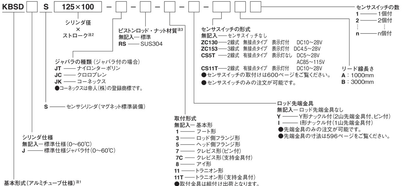
注1: KBSD形シリンダは、 $\phi 125, \phi 140, \phi 160$ のアルミチューブ仕様のシリンダです。オプションでセンサスイッチの装着が可能です。
