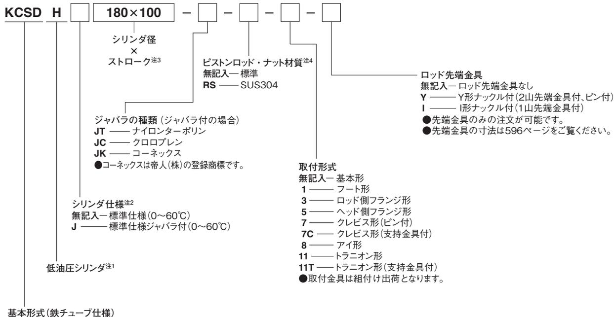
注1: KCSDH形シリンダは、φ180、φ200、φ250の鉄チューブ仕様の低油圧シリンダです。センサスイッチは取付けできません。
