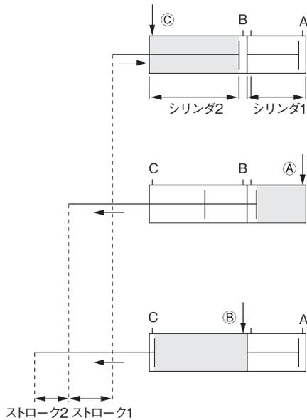
◎ポートより空気圧を供給すると、2、1両ストロークが引込みます。
