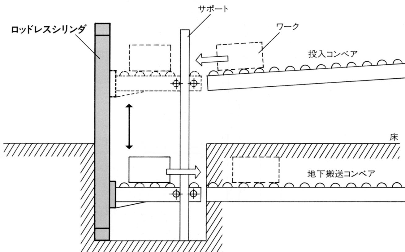
ロッドレスシリンダを使ったエレベータによって、投入コンベアから地下搬送コンベアへの搬送を行います。
