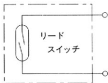
図2 リードスイッチのみを内蔵する有接点センサスイッチ
