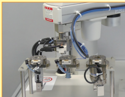
ハンドリングデモ実演 スカルロボット×ツールチェンジャ ハンド（エア & 電動）+バキュームパッド
