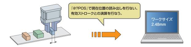
注:寸法測定の精度は、ガイド部に取り付けた爪の精度およびワークのグリップポイントに依存するので注意が必要です。
