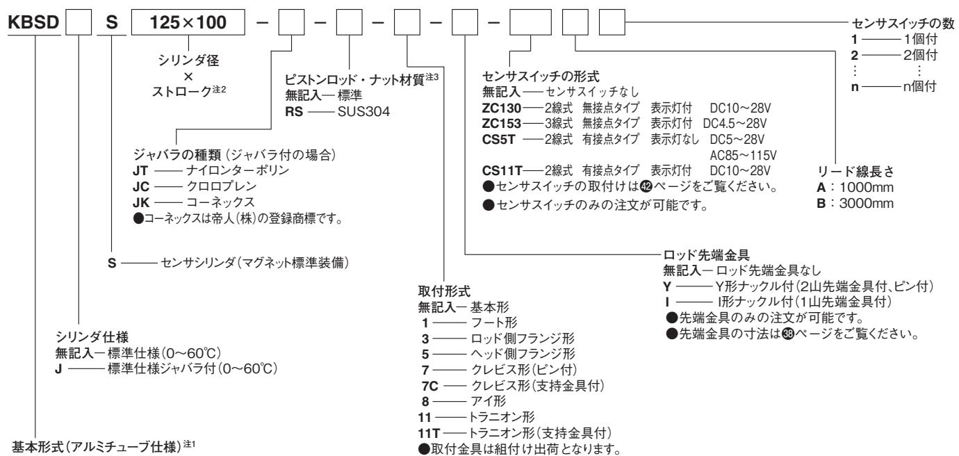
注1: KBSD形シリンダは、φ125、φ140、φ160のアルミチューブ仕様のシリンダです。オプションでセンサスイッチの装着が可能です。
