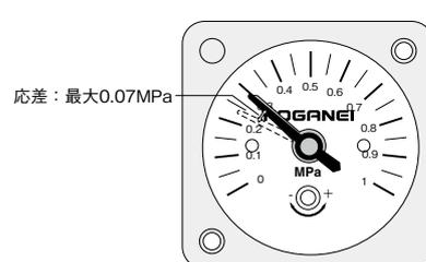
圧力が降下し、位置Aより圧力指針（黒針）が降下してから応差分（最大0.07MPa）以内に内部のスイッチはNC側に切り換ります。この時の切り換り位置を確認し、調圧指針（赤針）を調整してください。なお、NC側を負荷接点として使用することはできません。NO側のOFFによるリレーなどのB接点制御を行ってください。
