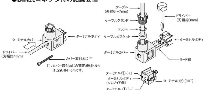
リード線は被覆をむき、各ターミナルボディ接続端子の奥に突きあたるまで挿入し、ドライバーでねじを締め込み接続してください。その際、軽く手で引張りリード線が抜けないことを確認してください。
