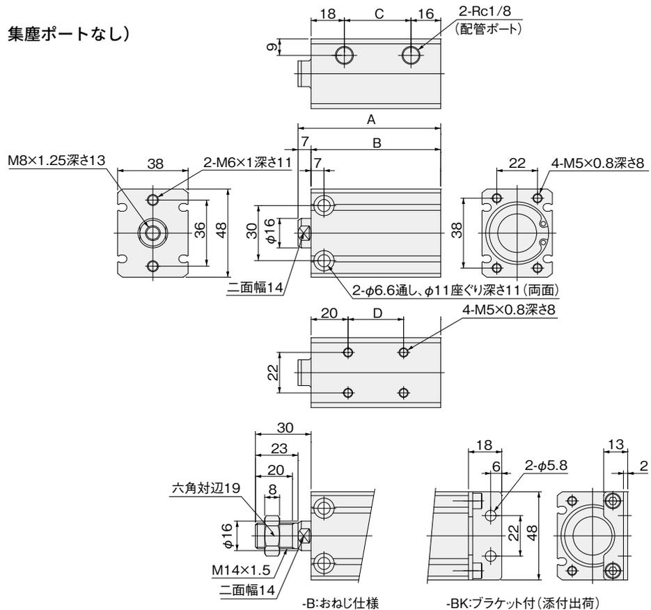
複動形クリーンシステム対応シリンダ寸法図 (mm)
