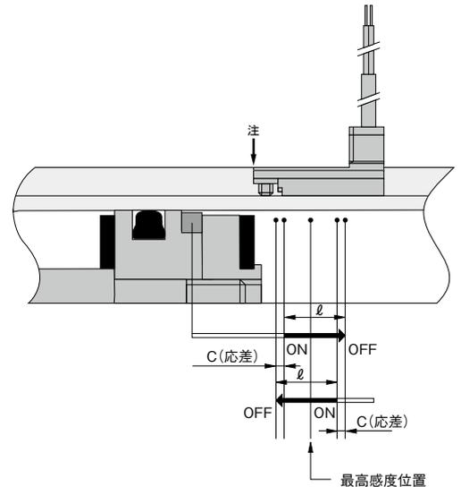
注1：センサスイッチ2個を上表の作動範囲以下のストロークで使用する場合、オーバーラップが生じ易くなりますのでご注意ください。
