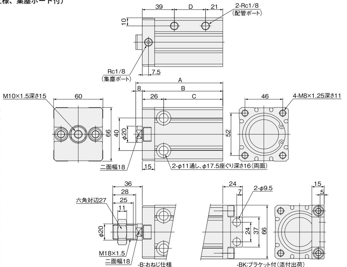
複動形寸法図 (mm)
