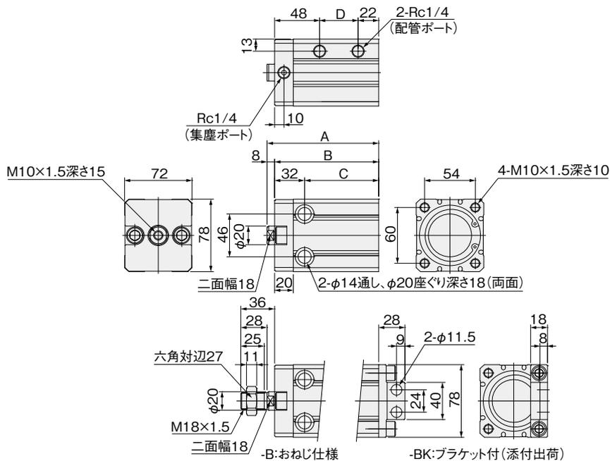
複動形寸法図 (mm)
